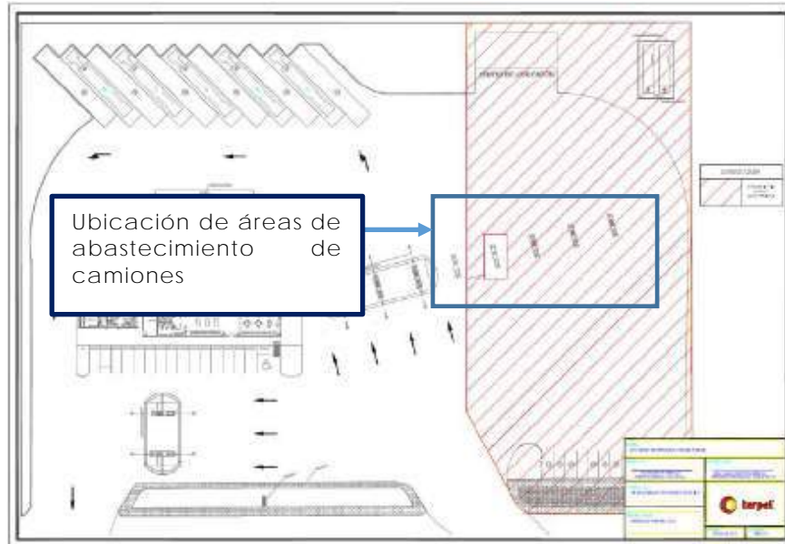
Figura 7-12, Ubicación de las áreas de abastecimiento de Diesel que se construirán en futuro
