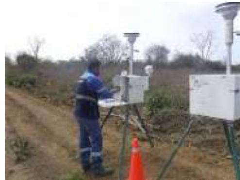
Fotografía 10. Instalación de los equipos de monitoreo de material particulado.
