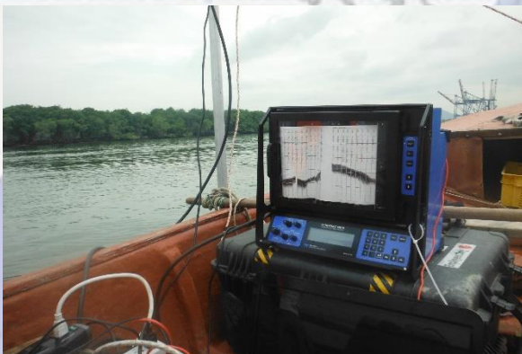
Batimetría, calibración del Ecosonda
